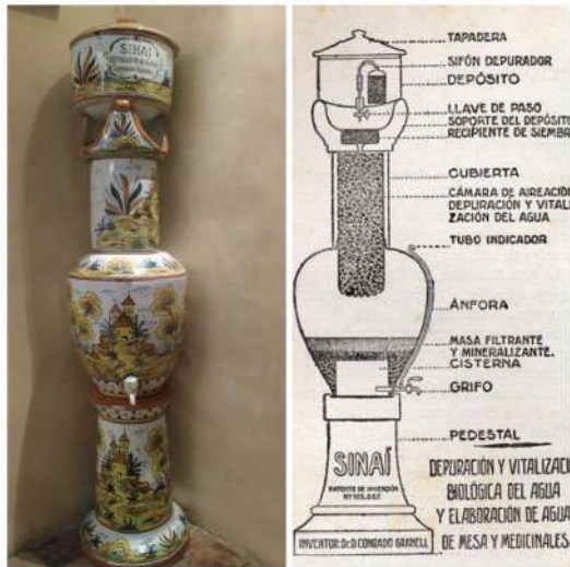
Ejemplar de un sinaí y las partes que lo componen
